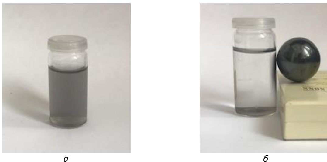
Рисунок 7. Типичный вид суспензии наночастиц магнетита до (а), и после (б) приложения к ней магнитного поля (видео по ссылке http://nanobiolab.ru/v/1.mp4 ).
