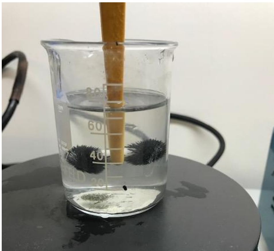
Рисунок 4. Фотография процесса очистки частиц магнетита с помощью магнитной мешалки (видео по ссылке http://nanobiolab.ru/v/3.mp4 ).
