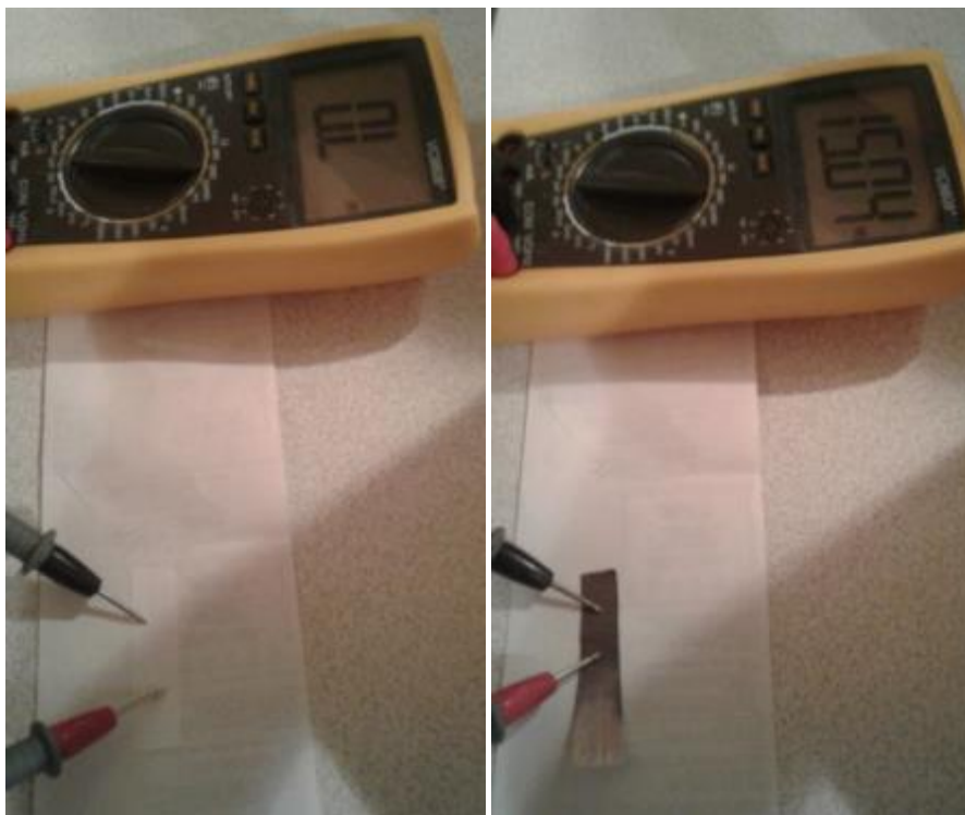
Рис. 10. Измерение проводимости полученной бумаги. Слева - чистая бумага, справа – бумага пропитанная чернилами.
