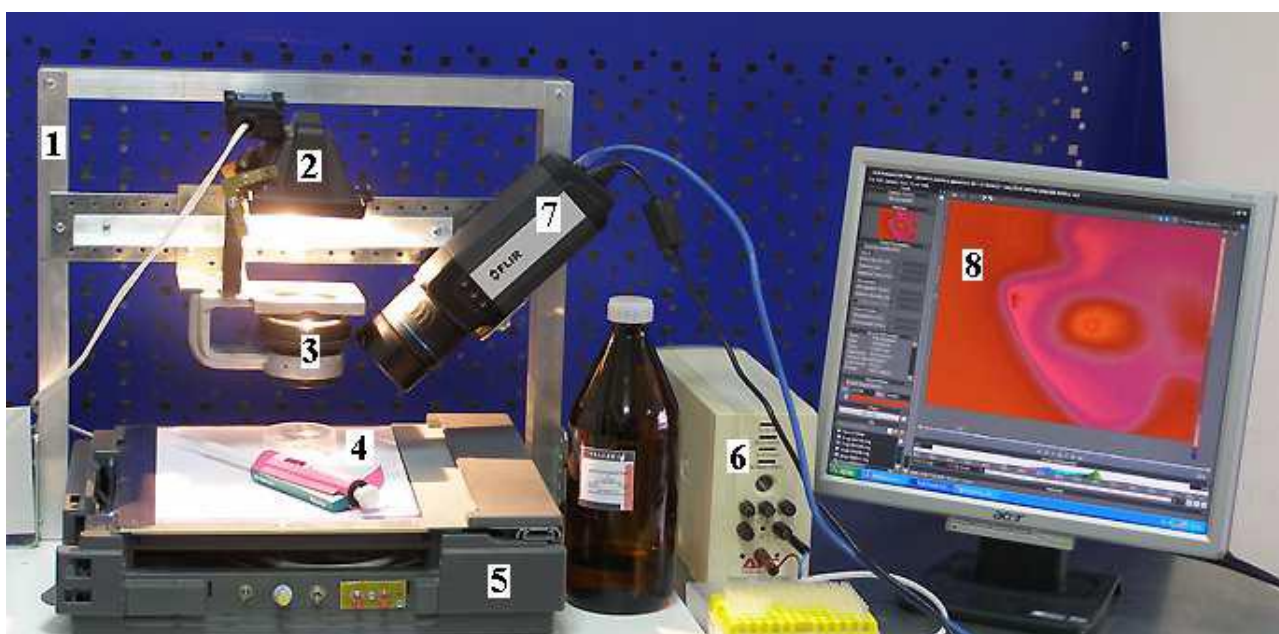
Рис. 2. Схема установки: 1 штатив, 2 галогеновая лампа в кожухе, 3 линза, 4 подложка, 5 платформа с подвижным столиком, 6 источник питания лампы, 7 тепловизор, 8 компьютер.
