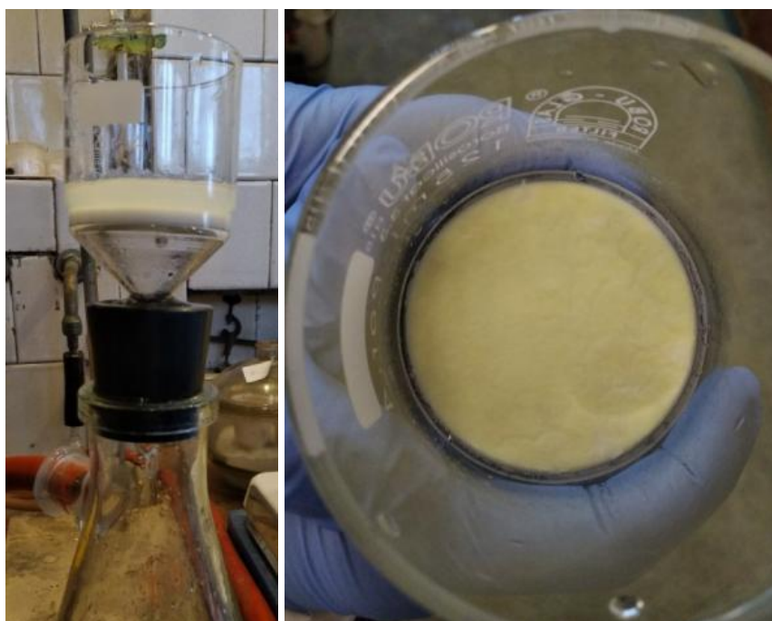
Рис.12. Получение плоского слоя геля – прототип бумаги
