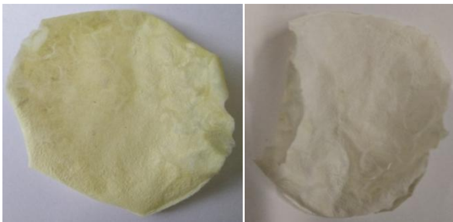
Рис.13. Церийфосфатная бумага после сушки и после отжига при 700°C (слева направо)
