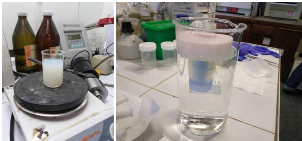
Рис.3. Внешний вид полученного геля и его промывка диализом
