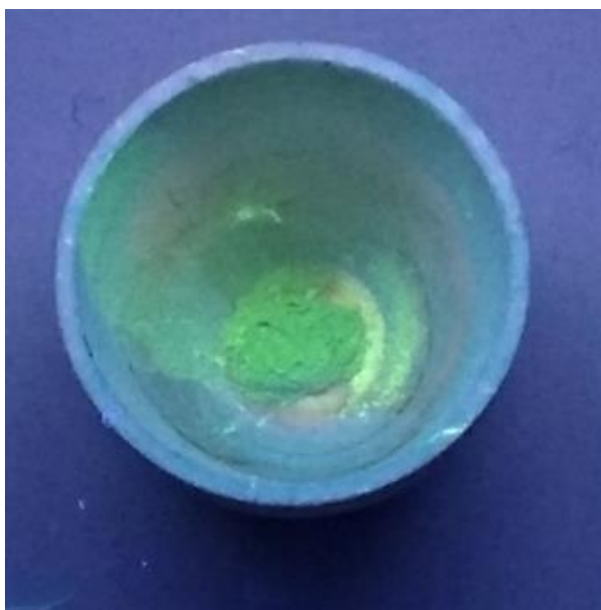
Рис.16. Люминесценция отожженного кристаллического ортофосфата церия (IV)
