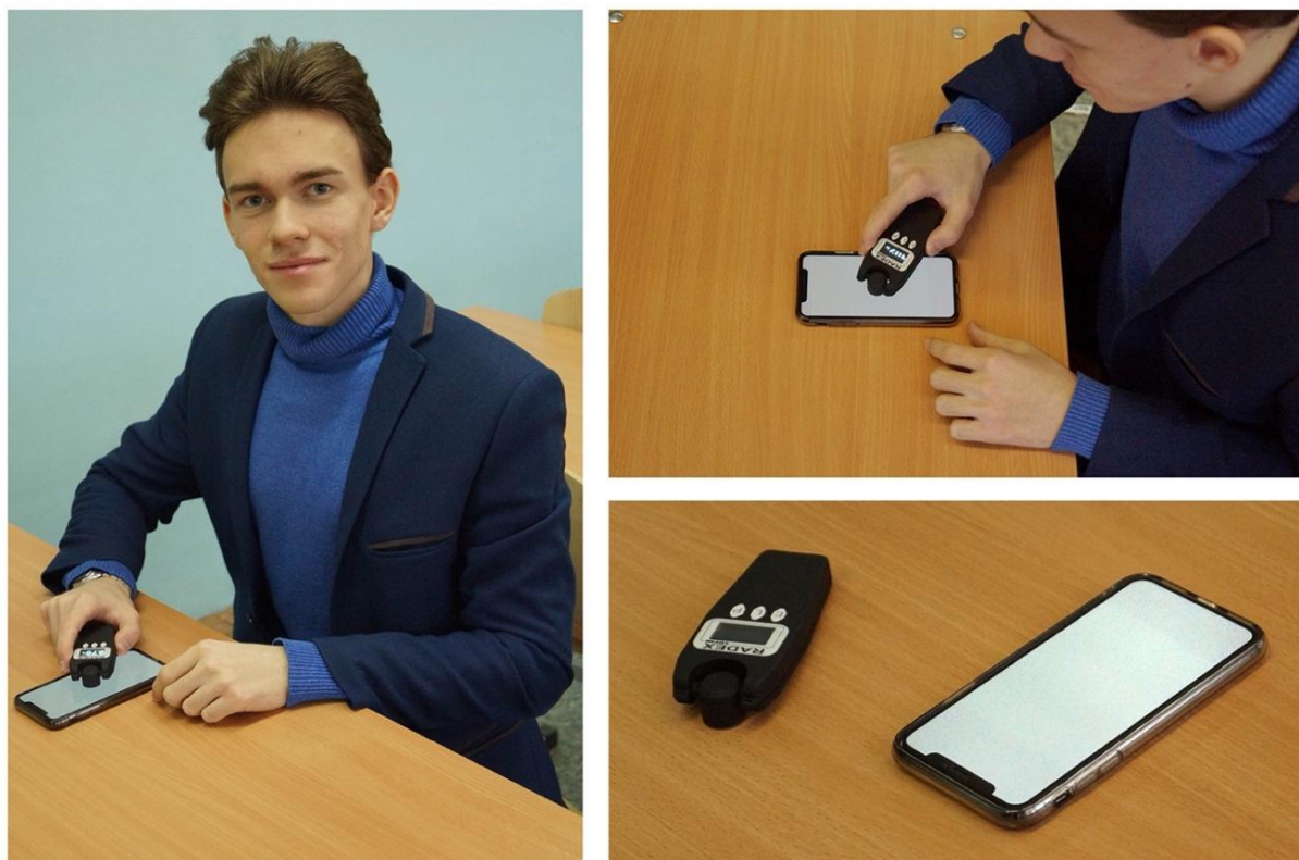
Рис.4. Предварительное тестирование люксметра-пульсметра
