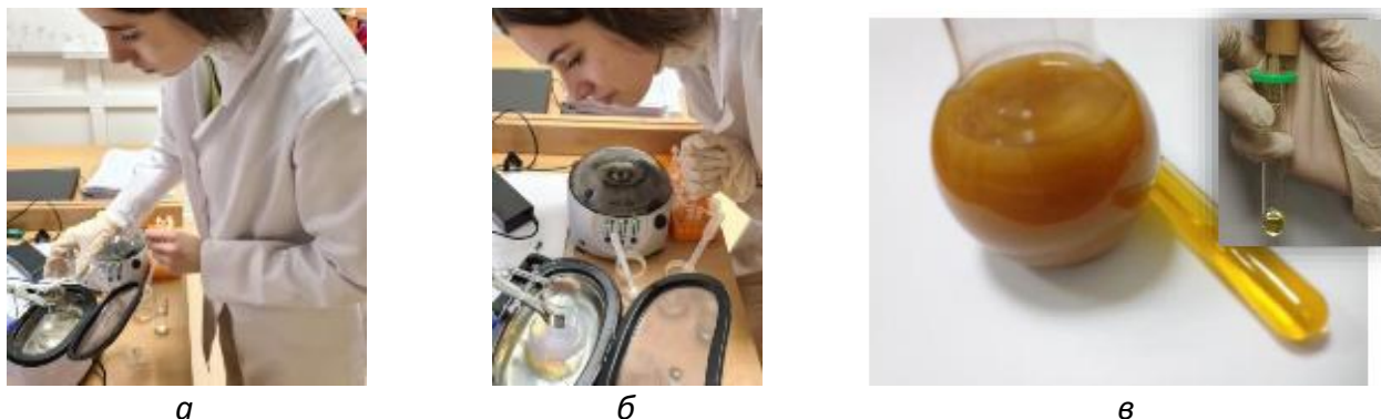
Рис. 9. Добавление р-ра \text{NH}_4\text{NO}_3 в реакционную смесь (а,б) и вид реакционной смеси через 30 мин УЗ обработки и продавливание продукта через шприцевой фильтр (в)
