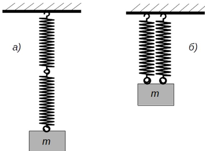
Первая пружина имеет коэффициент жесткости  $k_1$ , а вторая коэффициент жесткости  $k_2 = 2k_1$ . В случае а) грузик растягивает пружины на  $\Delta u_1$ , а в случае б) на  $\Delta u_2$ . Найдите отношение разности  $\Delta u_1 - \Delta u_2$  к удлинению одной пружины  $k_1$ , когда на ней висит тот же груз  $m$ .
